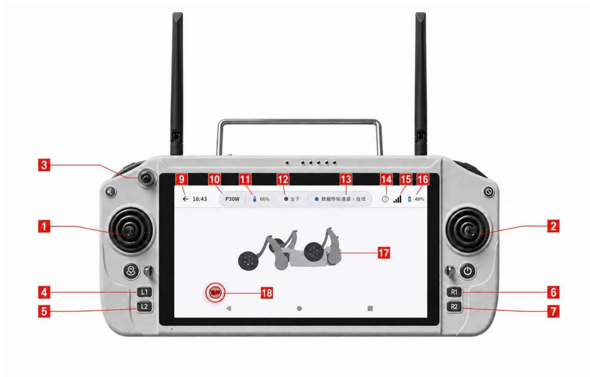
图 3-1 G20 智能遥控器与潜行遥控 App 控制页面编号示意图
