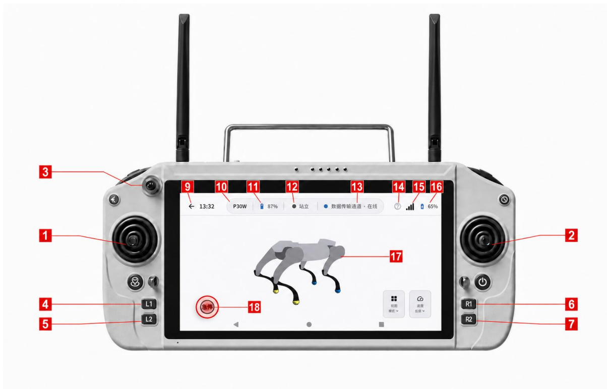
图 3-1 G20 智能遥控器与潜行遥控 App 控制页面编号示意图（屏幕示例以实际连接型号为准）
